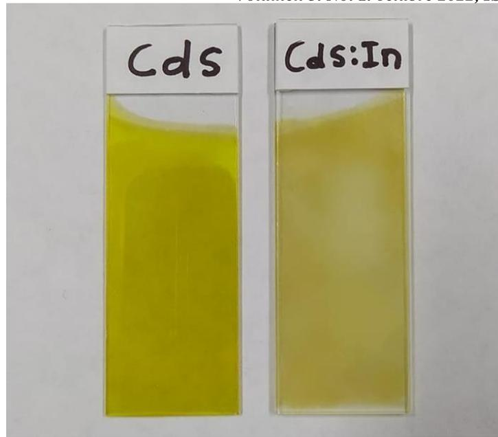
Figura 7. Imagen real de películas delgadas de CdS (a) y CdS:In 1mM (b) fabricadas a través de la técnica CBD
