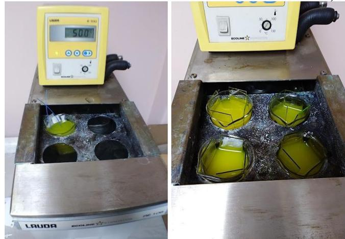
Figura 3. Baño termostático para la obtención de películas de CdS y CdS:In
