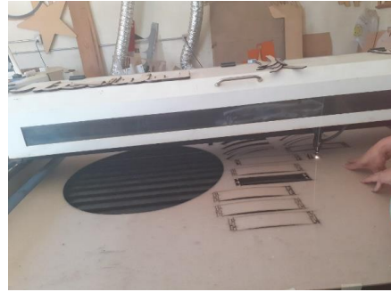
Figuras 10 y 11. Base o antepecho para la geodésica, se utilizó tecnología en laser de acuerdo a planos de diseño, construidos con cartón reciclable.
