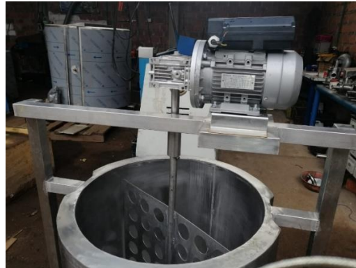
Figura 22. Instalación del motor a la estructura mecánica. Presente proyecto
