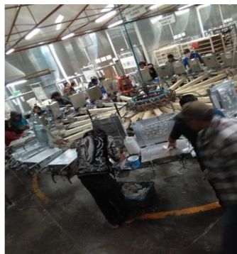
Figura 1. Limpieza de moldes del carrusel Cannon
