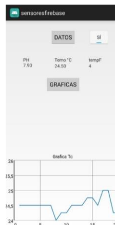
Figura 6. Aplicación para el control y monitoreo del equipo desde un dispositivo Android, grafica de temperatura. presente proyecto
