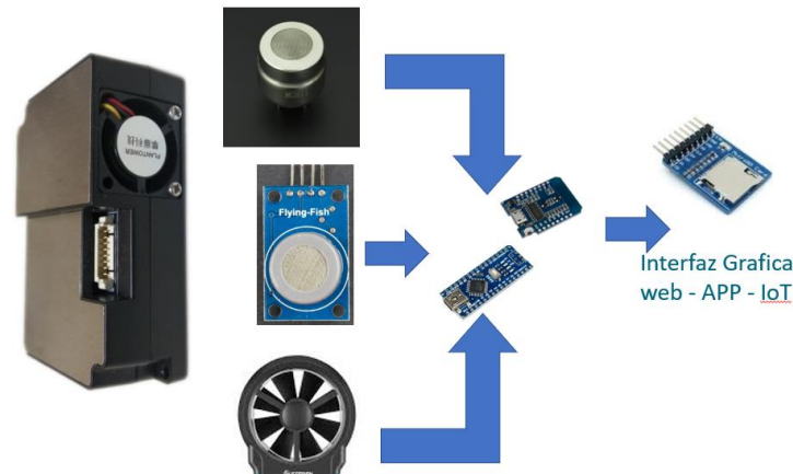
Figura 1. Sistema de Medición, MQ7, MQ135, Shield MicroSD, WEMosD1, Sensor de Polvo SB5003, IoT,
