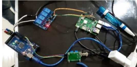
Figura 9. Montaje del Arduino y Raspberry con la lectura de los sensores. presente proyecto
